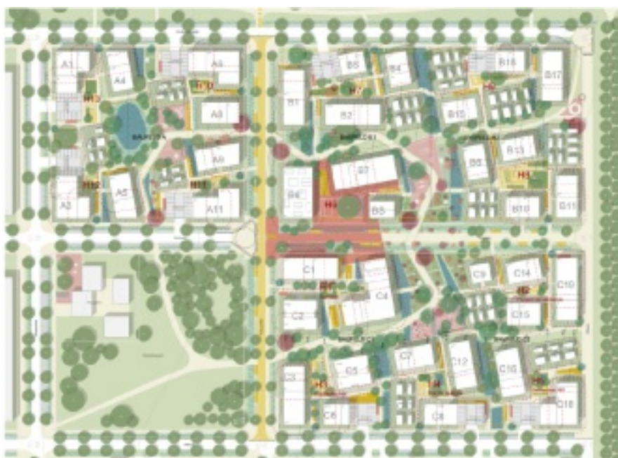
Plan över den nya ekobyen i Hannover. Bostäderna ligger i grupper kring gemensamma gårdar med ett centralt torg i mitten. I varje grupp finns också tomter för "tiny houses". Plan Cityförster.
